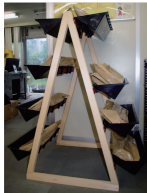
新たに開発し、特許を出願した「傾斜プランター」の両流れタイプ。水やりをすると、オーバーフローしたものが上から下へ効率よく落ちていく仕組みになっている。
