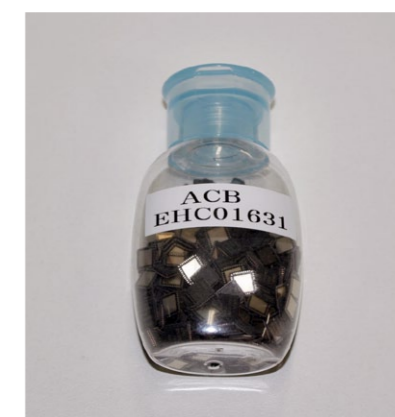
アクティブ・セルバランスを実現するICチップ。
