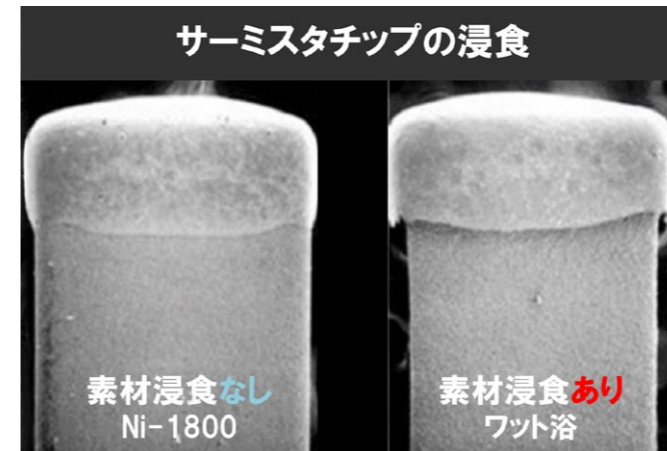
受動部品の高性能化に伴い、部品素材(セラミック)が耐薬品性に弱い材料に変更される傾向がある。同社のNi(ニッケル)めっきは素材を侵さず部品特性が維持できることから好評を得ている。
