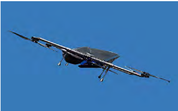
独自の機体構造設計技術『4D GRAVITY®』により、機体が傾いても荷物は水平を保つ、安定性とエネルギー効率を両立した飛行を実現
