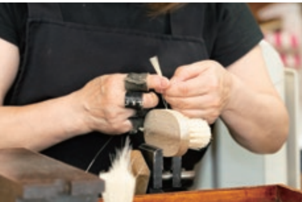
板に穴を明け、一つひとつ手作業で植毛する
