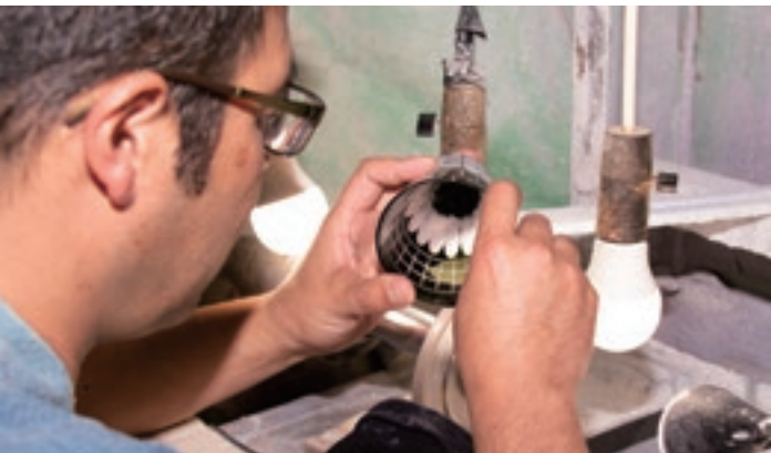
回転する円盤状のダイヤモンド盤でガラスを削る作業
