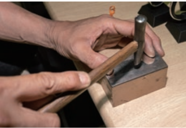
「あて金」という台の上に材料の銀をのせて槌で叩く（鍛金）作業
