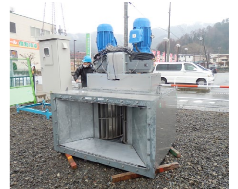
流水式小水力発電装置の水車・増速機・発電機。出力タイプ別の標準化によって、共用部品・汎用部品による仕様とし、安価なユニット化を実現している。
