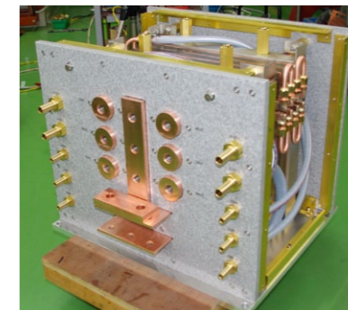
リアクトルとは、電気回路のインダクタンス素子となる静止巻線機器のこと。同社は高周波用リアクトルでも特許を取得している。
