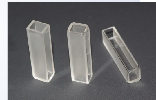
鬼塚硝子の血液検査用ガラスセル。底面と壁面の5面で構成され、角柱状になっている。円柱状のものよりも、垂直方向から光を当てられるため、計測しやすいというメリットがある。
