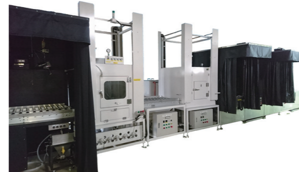
②浸透探傷装置 大量の検査物の場合に均一な精度で浸透探傷処理できる。
