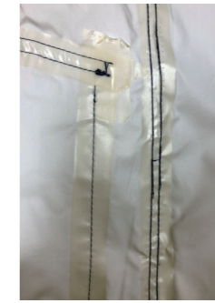
針穴からの雨の侵入を防ぐため、テープで補修
