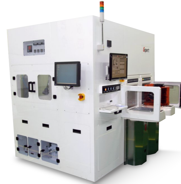
Expert™という全自動気相分解 (VPD) 装置。前処理濃縮法として気相分析法を採用し、得られた回収溶液をICP-MS(誘導結合プラズマ質量分析装置)で自動的に分析し、シリコンウェーハ中の微量金属不純物のオンライン分析を行う。
