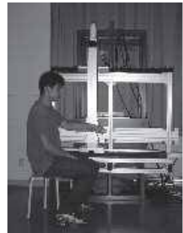
図 2. 起立支援装置 2本のアクチュエータの交点に手すりが設置されている
