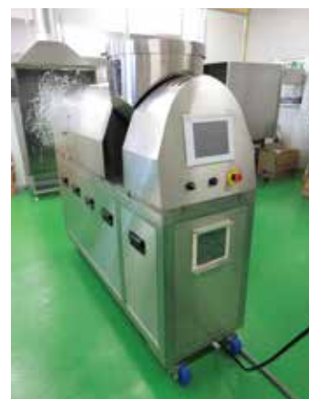
完成したナノファイバー量産製造装置
