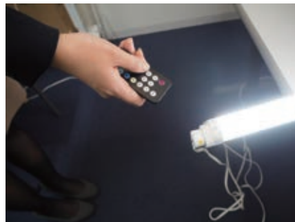
手元のリモコンで簡単に波長を調整できる
