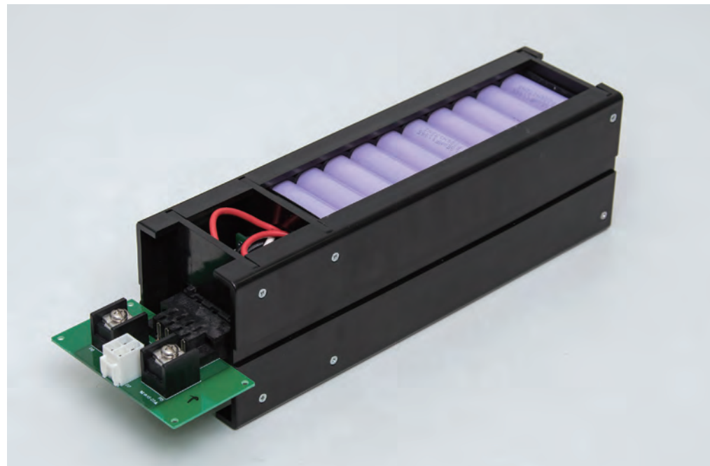
コンパクトかつ組み立てやすい形に改良されたリチウムイオン電池樹脂ケース
