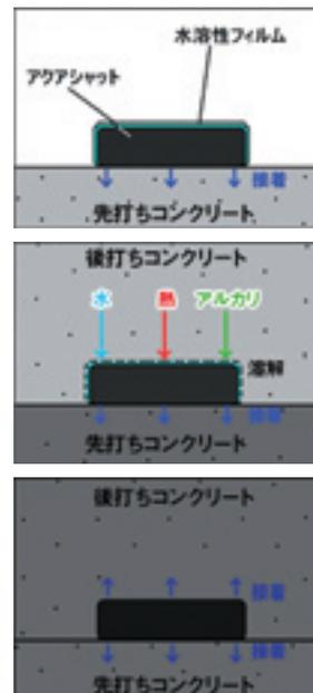
離型紙を剥がした側が先にコンクリートに接着します。水溶性フィルム側はまだ接着性はありません。
