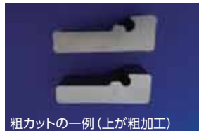
粗カットの一例（上が粗加工）
