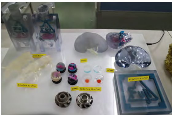
ブラスト技術による3Dプリンタ造形品の積層段差の除去や可視化
