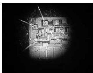
顕微鏡で覗いた開封後のIC
