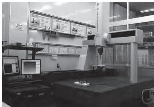
成長産業等設備投資特別支援助成事業を利用して導入した、大型同時5軸制御可能なマシニングセンタ(左)と1,600mmまで測定可能な三次元測定機(右)
