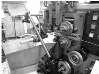
単純なつくりだが、 ノウハウが詰め込まれているばね製造器
