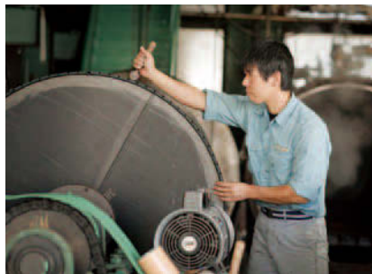
ベルトコンベアなどに使われる「プーリー」。耐摩耗性などが高く、顧客から強く支持されている
