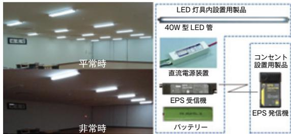
平常時は非常時仕様を意識せずに使用でき、停電時に電源供給がストップしても点灯する事で非常時対応の真価を発揮します。無線を使用している事により、停電時でも点灯・消灯のコントロールが可能。停電時でも4時間程度の点灯が可能。停電時には元の状態が点灯でも消灯でも自動的に点灯、停電復旧時には自動的に元の状態に戻ります。
