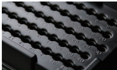
開口φ28に対し、h15mm、比率1:5.3の深絞りを実現したトレイ。(通常比率1:1)
