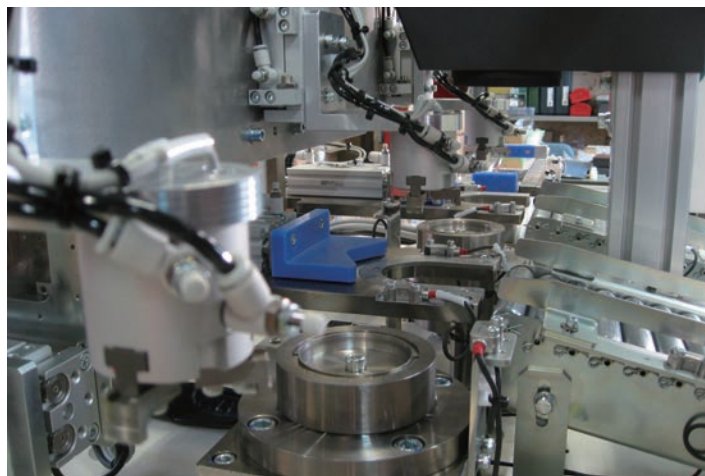
寸法測定装置：レーザセンサやリニアセンシング技術を応用して、ミクロン単位の寸法測定を行う装置
