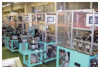
自動組立装置：ギヤ、ローラ、軸、端子、グリース塗付など、自動供給しながら組立を行う装置
