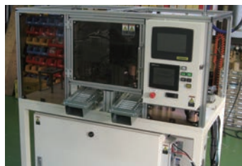
画像検査装置：キズ、ダコン、組立不良、加工不良などを画像認識で検査を行う装置
