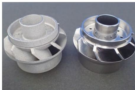
3D プリンター金属造形品の積層段差の鏡面化 (左：加工前 右：加工後)
