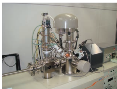
X線光電子分光装置へ赤外線導入加熱装置の取付例
