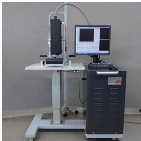
スーパーコンティニューム光源を用いた光干渉断層計
