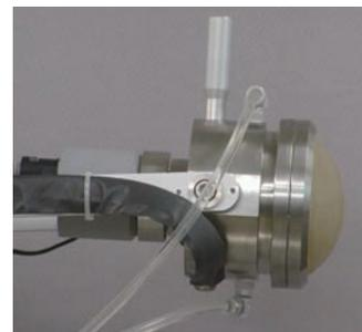
水中スパーク放電を用いた衝撃波発生装置
