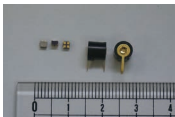
新製品振動センサと従来品振動センサの大きさ比較
