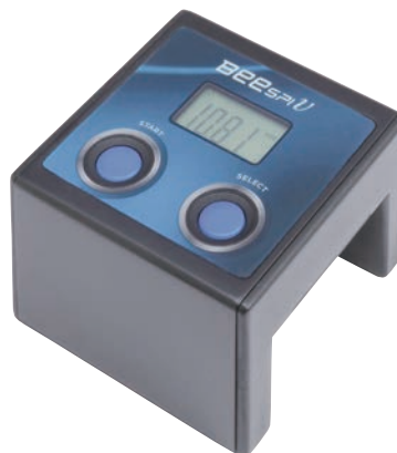
本体内側にある2カ所の赤外線センサ部分を物体が通過する時間差から、速度・積算ラップタイム、2個用いれば加速度の算出も可能です。
