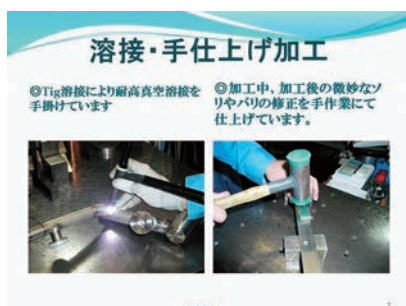
溶接・手仕上げ
