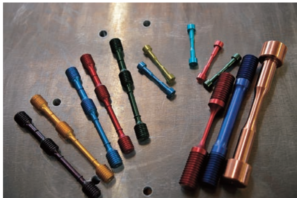
材料試験片(展示用のため着色)
