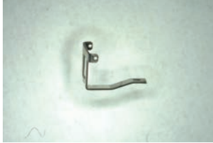
SUS301 t 0.1 全長 2 mm 精度±0.05mm 以下
