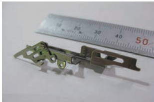
SUS430 t 0.6 全長45mm 精密板金加工
