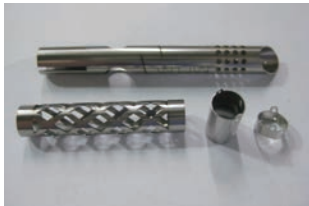
SUS304 φ 5 t 0.15パイプへのレーザー加工
