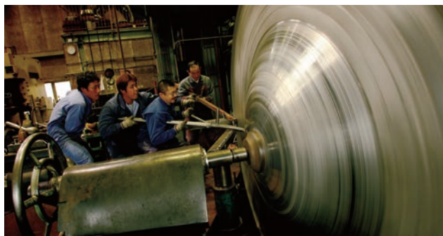
φ2500パラボラアンテナへら絞り加工
