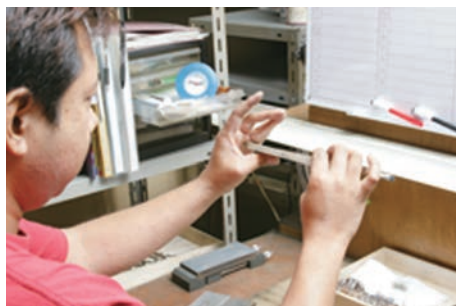
鋏の隙間0.2mmの調整と確認
