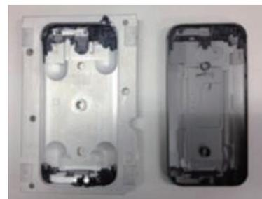
金属と樹脂の接合技術(NMT)応用製品(携帯電話)製作過程
