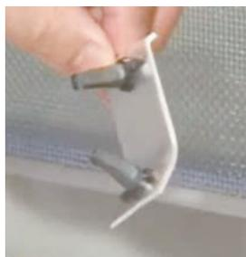
NMTの接合部は強固なので、ハンマーで叩いても、樹脂は取れず、アルミ板の方が曲がってしまいます。
