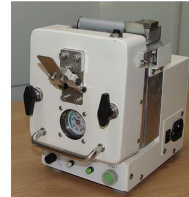
ラミネートセル用の「真空シーラー」。グローブボックス（密閉容器）での作業に特化し、サイズ、操作性、視認性などにおいて優れている。
