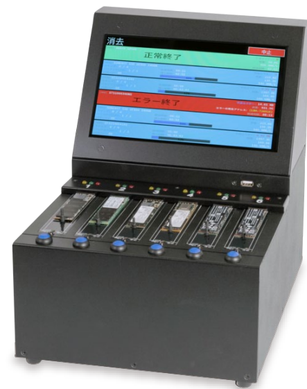
データ消去機。サーバールームへの持ち込み作業に最適なスタンドアローン型であり、すべての消去作業をライセンスフリーで実行できる。
