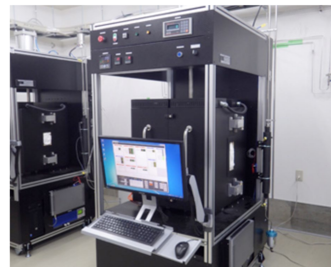
高い安定性のある多機能な SOFC 専用の評価装置も開発している。
