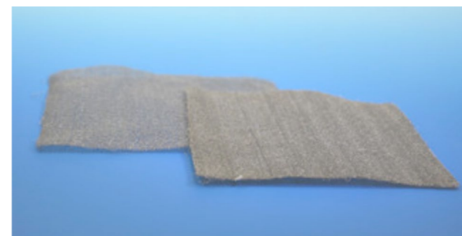
SOFC 発電セルとインターコネクタの良好な電氣的接触性を維持するため、金属繊維ニットを配設した集電材を開発し、特許を取得している。
