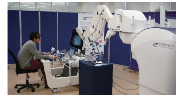
執刀医が手元のコンソールを操作して、患者の体内に挿入されたマニピュレータを動かして手術を行う。空気圧制御の採用により、「ひとにやさしく繊細な力制御」をすることができる。遠隔手術も可能。
