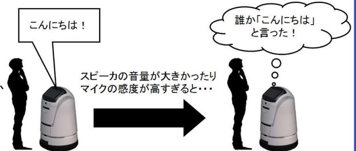
図1. ロボットが自分の声に反応してしまう問題
