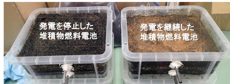
図-4 発電の有無による堆積物(濃縮下水汚泥)の色の違い
