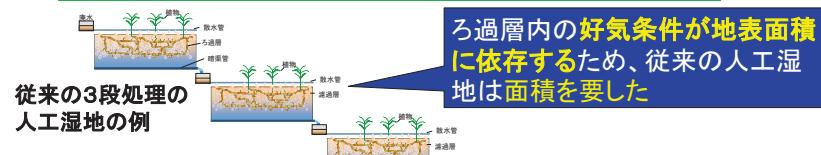
大気が自然拡散する空気層を地下に設置する技術により、ろ過層内の好気条件を地表面積に依存することなく維持することに成功！
