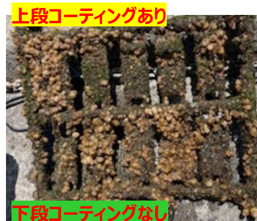
同左試験後（上段は付着が少ない）
