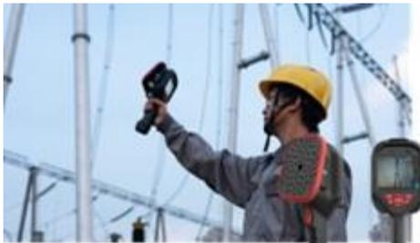
産業環境での空気・蒸気の漏れの特定や、高電圧システムの部分放電の検出。軽量で取り扱いも簡単。
