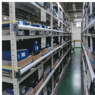
棚板上物品落下防止： ドロップストッパー 複合機の移動防止： リンクワイヤーストッパー
