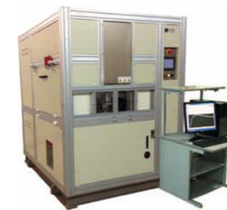
タイヤの摩擦性能を評価する「RTM摩擦試験機」。実車の走行条件に合わせ、スピードや荷重、温度などの条件を細かく設定できる
