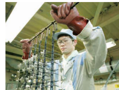
銀めっきを施している現場の様子
