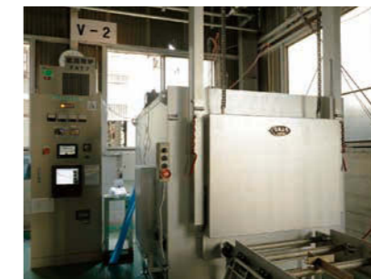
会社の「革新的事業展開設備投資支援事業」を活用して導入した、低温焼き戻しの専用機。特注品で、要求水準の厳しい製品にも対応できる
