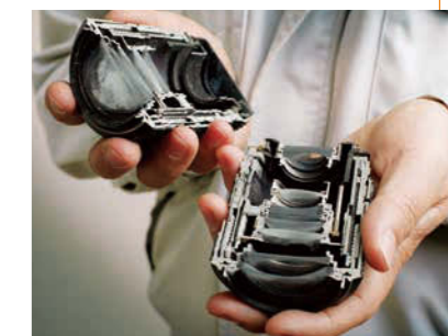
加工するモノに対する負担が小さいため、製品の内部を調べる検査にもよく使われる
