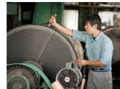
ベルトコンベアなどに使われる「プリー」。耐摩耗性などが高く、顧客から強く支持されている
