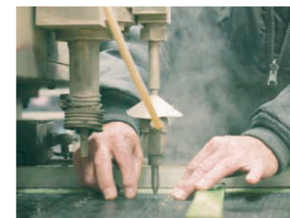
高圧の水流で素材を加工。水と天然石の研磨剤だけしか使わないため、環境にもやさしい
