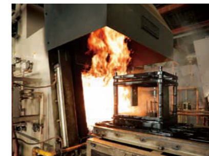
工場内に設置された炉。加熱と冷却を行うことで、金属を目的通りに加工していく
