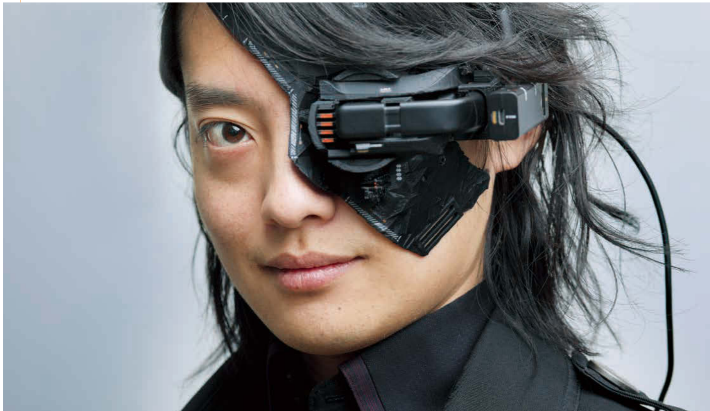
代表取締役 CEOの吉藤オリィ氏がつけているのは、体に装着して使える「OriHime eye」の試作品。通常のOriHime eyeは、視線入力装置とパソコンなどを組み合わせて使う
