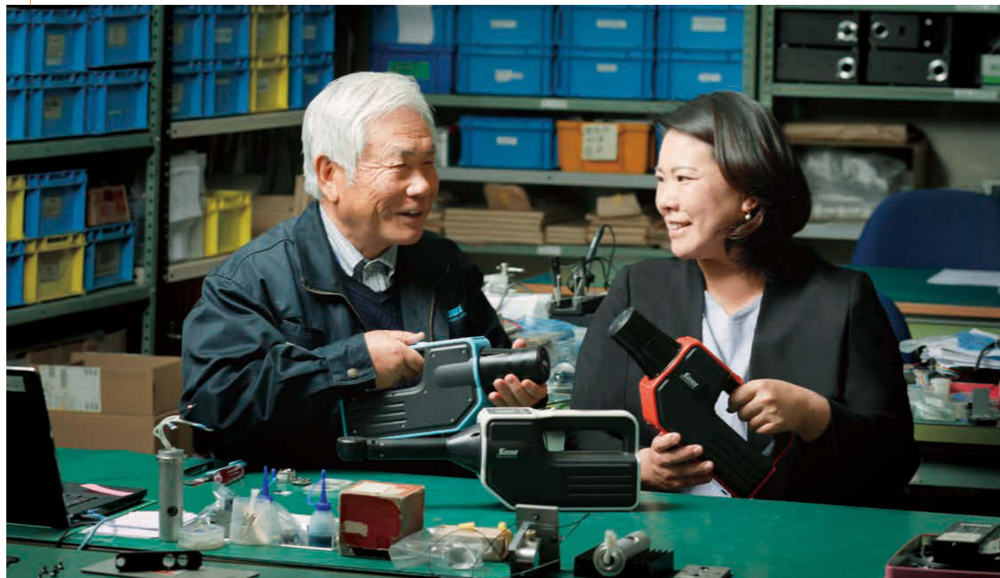
代表取締役会長の浦信夫氏(左)と代表取締役社長の明子氏(右)が手にしているのは、近赤外光を利用したマグロの脂肪含量測定装置「PiPITORO」
