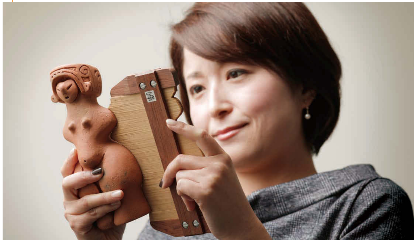
河野氏が手にしているのは、出土品の形状や輪郭を測るために使われる「真弧(まこ)」。第一合成のオリジナル製品で、日本全国、そして世界の発掘現場や研究所で愛用されている
