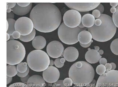
遠心力を使った製造装置は、大きさがそろい真球に近い金属粉を生み出すことができる
