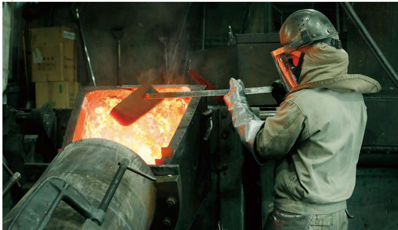
溶かした銅合金を鑄型に流し込んでいる様子。中小企業の場合、鑄造、鍛造、加工などいずれかの工程に特化した企業が多いのだが、大和合金、三芳合金工業では全工程を一貫して行えるのが強みだ
