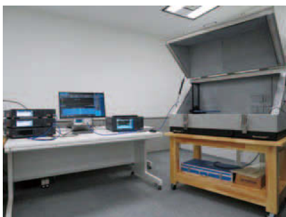
図2 無線妨害電波耐性、伝搬特性評価システム
